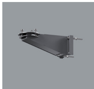
34955.000 Braccio per il montaggio dell'apparecchio in verticale su piantana a tubo da Ø 60- 89mm o sulla parete. Corpo: acciaio legato. Verniciato a polvere in graphit m. Per il fissaggio su piantane a tubo ordinare a parte una piastra di fissaggio o un secondo braccio. Ordinare la piantana a tubo da Ø 60- 89mm a parte. Peso 2,20kg
