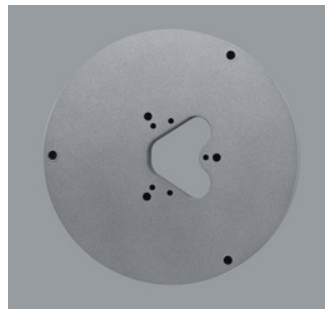
33982.000 Piastra di montaggio Fusione di alluminio anticorrosione, trattamento no-rinse delle superfici. Verniciato a polvere a doppio strato in graphit m. Peso 1,70kg
